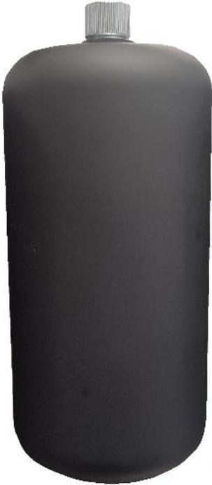
Fox H1000R, Acumulador de membrana Fox de la serie H, volumen de nitrógeno de 1L con rosca métrica de M18X1,50 y con válvula de carga con rosca 5/8 UNF. (Presión máxima 250BAR)
