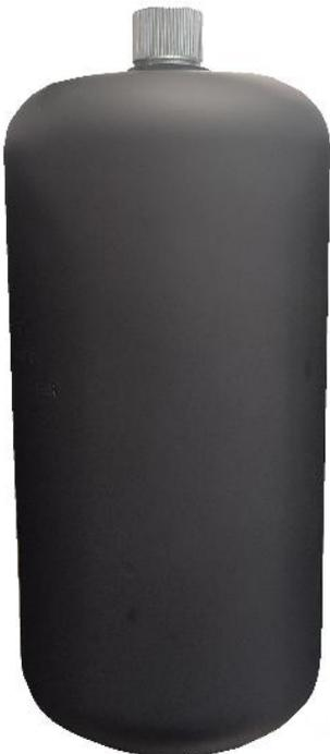
Fox H1400R, Acumulador de membrana Fox de la serie H, volumen de nitrógeno de 1,4L con rosca métrica de M18X1,50 y con válvula de carga con rosca 5/8 UNF. (Presión máxima 250BAR)
