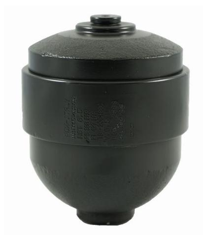
Fox HST0.35, Acumulador de membrana Fox de la serie HST, volumen de nitrógeno de 0,35L con rosca métrica de M18X1,50 y con válvula de carga con rosca 5/8 UNF. Cargado a 200BAR. (Presión máxima 300BAR)
