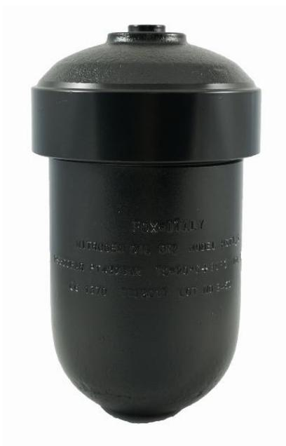
Fox HST1.5, Acumulador de membrana Fox de la serie HST, volumen de nitrógeno de 1,5L con rosca métrica de M18X1,50 y con válvula de carga con rosca 5/8 UNF. Cargado a 150BAR. (Presión máxima 300BAR)
