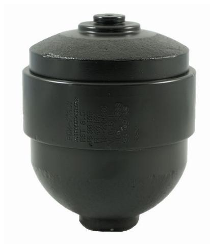
Fox HST0.15, Acumulador de membrana Fox de la serie HST, volumen de nitrógeno de 0,15L con rosca métrica de M18X1,50 y con válvula de carga con rosca 5/8 UNF. Cargado a 200BAR. (Presión máxima 300BAR)
