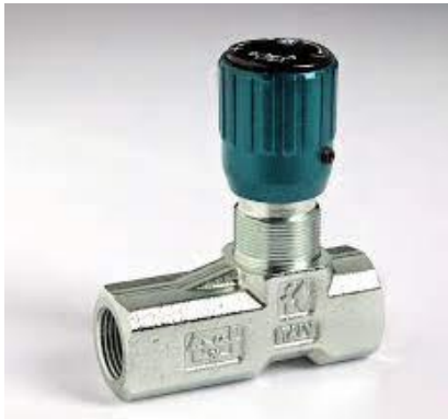
Tognella FT251/5-S-38, Válvula reguladora unidireccional en línea, con roscas hembra 3/8 BSP en los dos lados. (350BAR)
