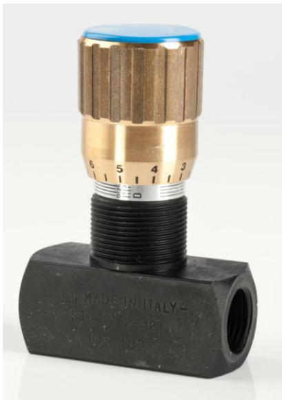
Tognella FT257/2-14, Válvula reguladora bidireccional en línea, con roscas hembra 1/4 BSP en los dos lados. (400BAR)
