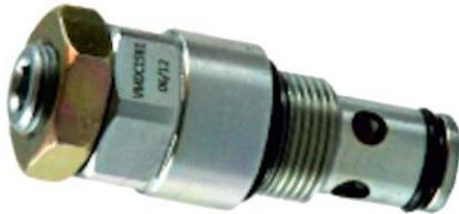
Hydronit VMDC15L1, Válvula limitadora de presión de 10 a 60 BAR con rosca métrica M14X1,00. Regulación por tornillo.
