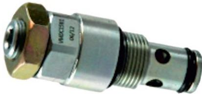
Hydronit VMDC15B1, Válvula limitadora de presión de 20 a 280 BAR con rosca métrica M14X1,00. Regulación por tornillo.
